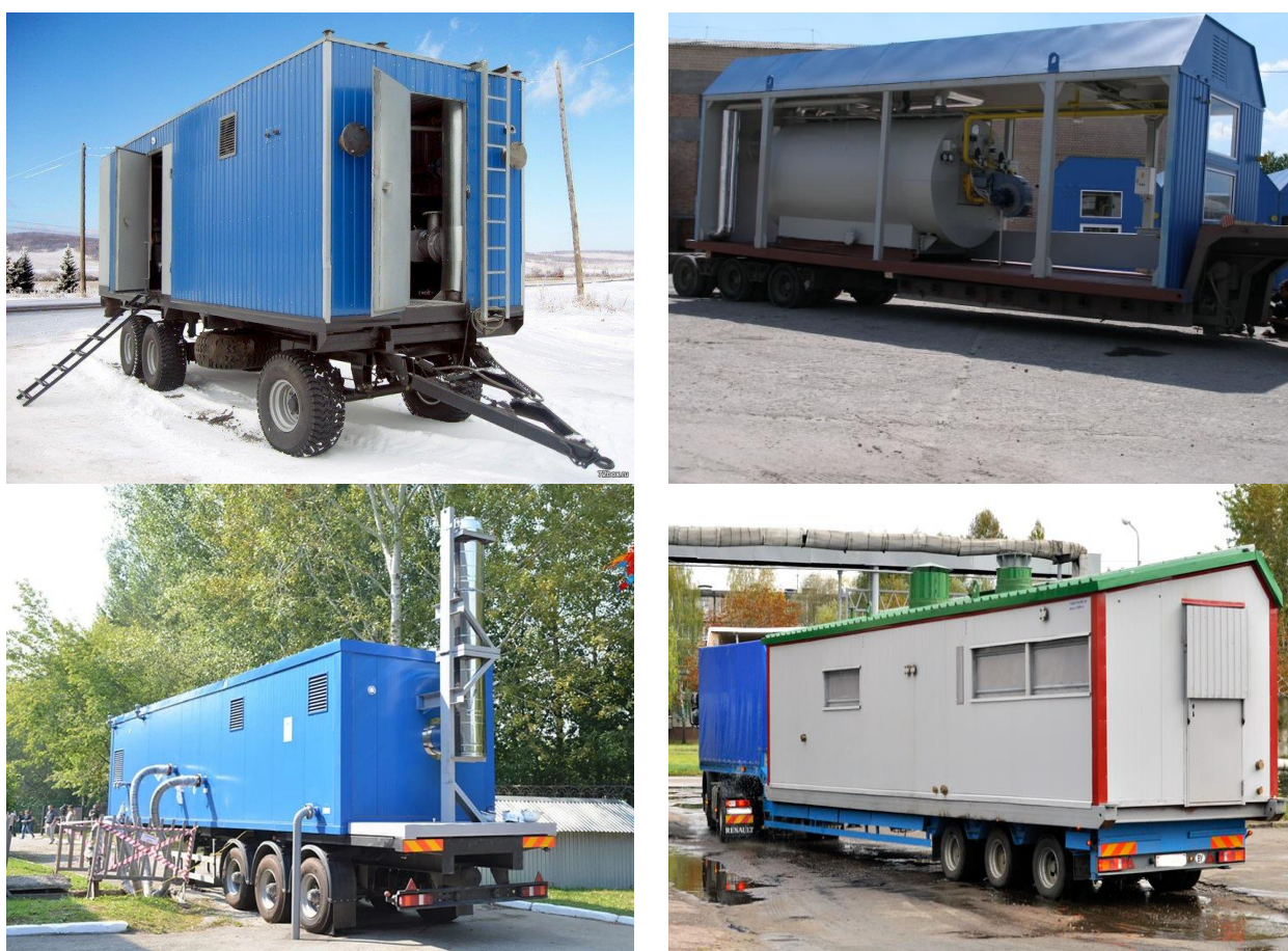
Рисунок 8 – Внешний вид передвижных котельных установок
